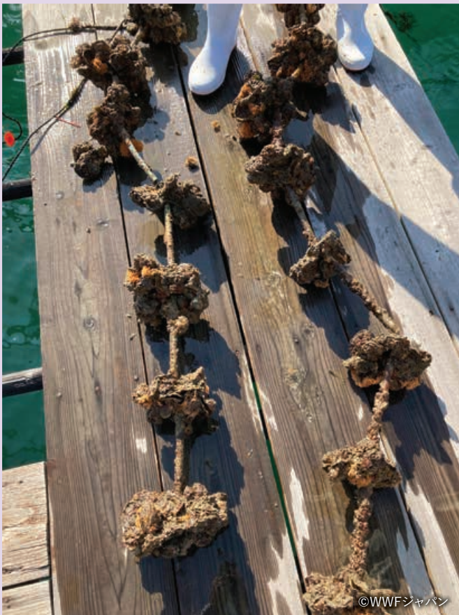
ダイセル社と広島県がテスト中の酢酸セルロース（非可食性海洋生分解性素材）で作られたカキパイプとテスト筏
